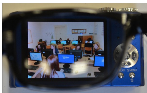
Obr. 2: Stejný displej přes polarizační brýle
