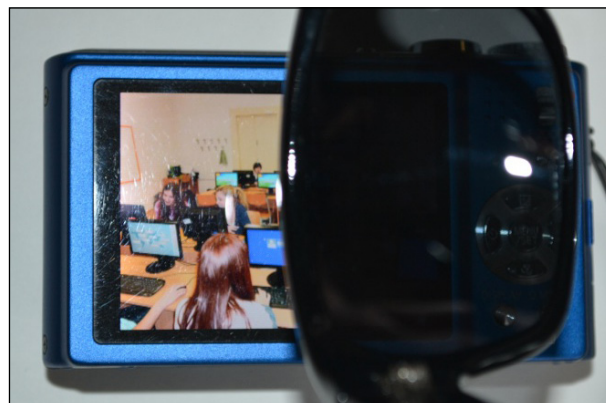
Obr. 4: Natočení brýlí o 90°, efekt ztmavnutí displeje
